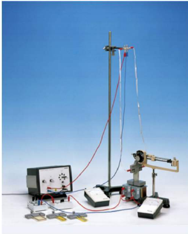
Figura 5.1: Montagem da balança e o condutor.
