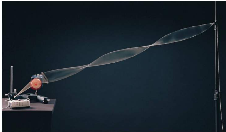
Figura 3.1: Montagem do experimento sobre oscilações forçadas.
