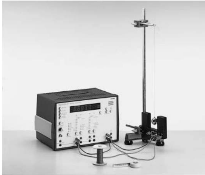
Figura 2.2: Mostra a montagem do pêndulo simples.
